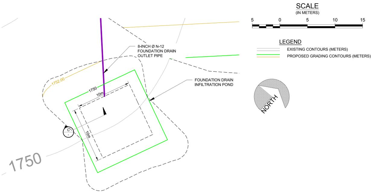
**FOUNDATION DRAIN INFILTRATION POND
